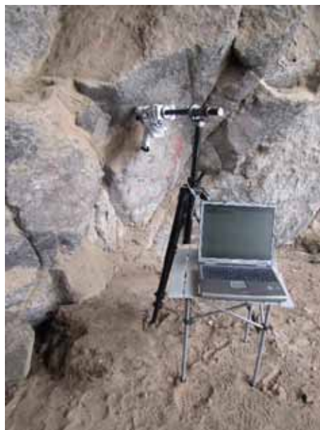
FIG.1. Equipo Fluorescencia de Rayos X in situ.
