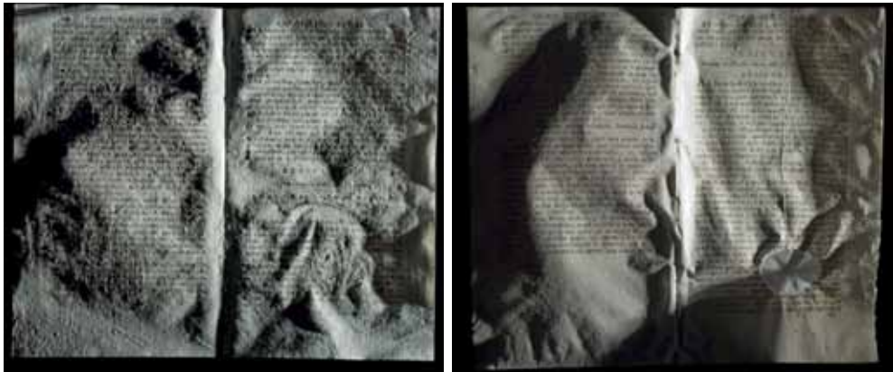
FIG. 6. Fotografía con iluminación rasante: (izquierda) injerto de algodón, (derecha) injerto de NCC. Deformaciones evidenciadas.
