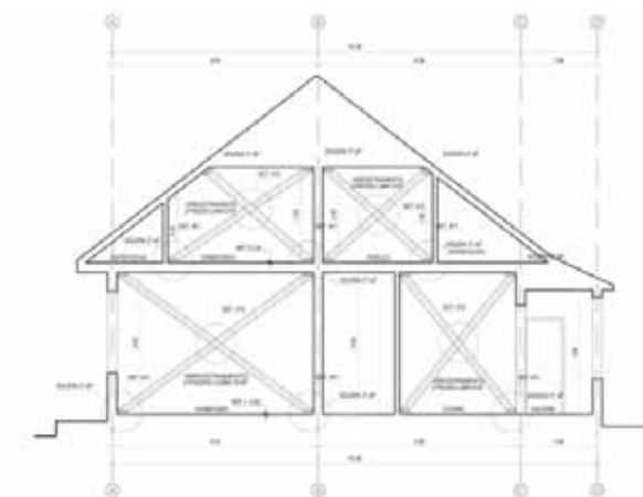
FIG. 3. Corte graficando los arriostramientos interiores o "tijeras" (Inostroza, C. 2008)
