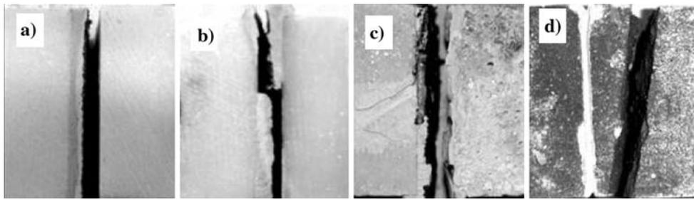
**Fig. 3** Failure modes: (a) ITZ, (b) Z, (c) G, (d) S
