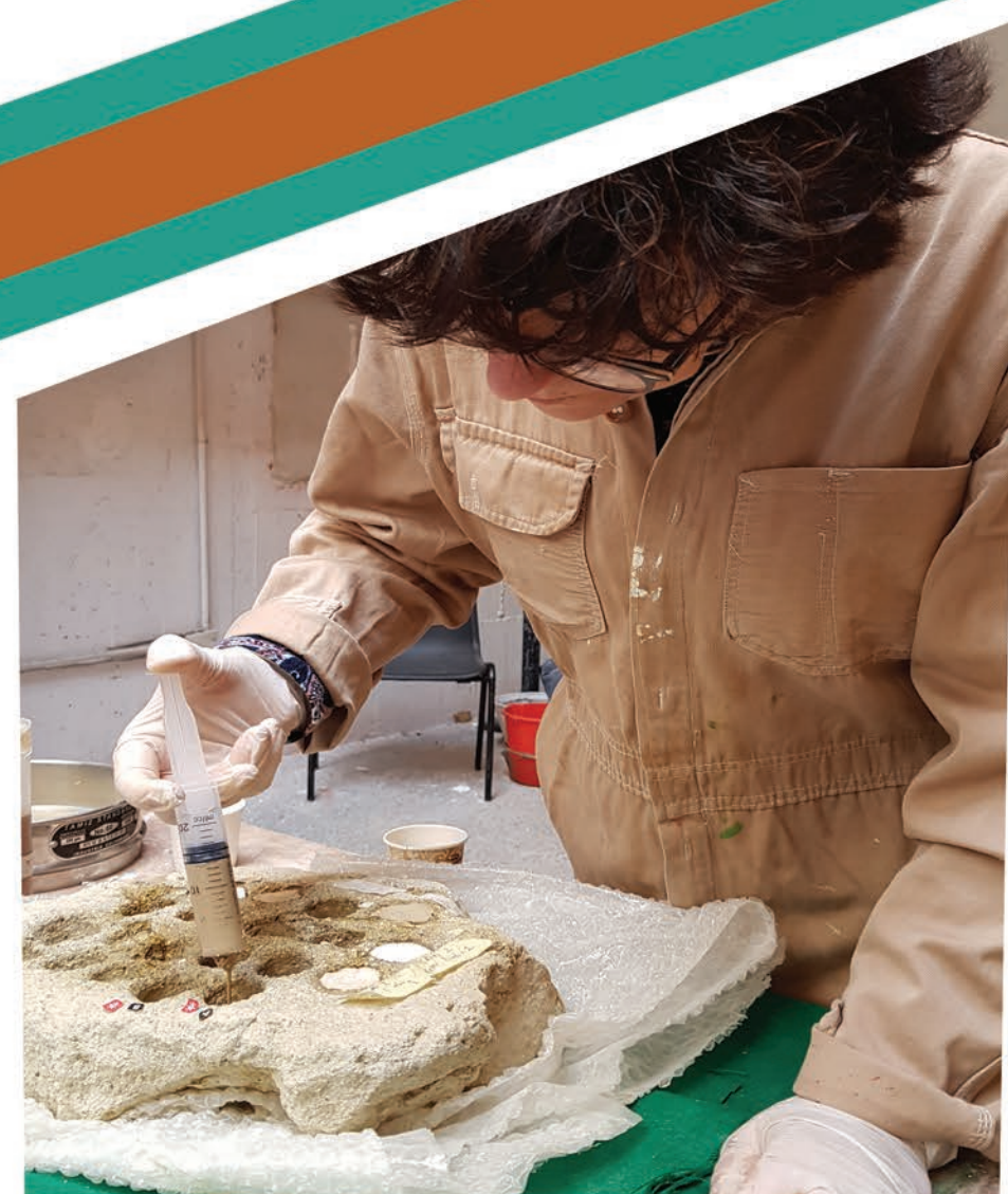
Pruebas de diferentes mezclas de morteros de inyección.
