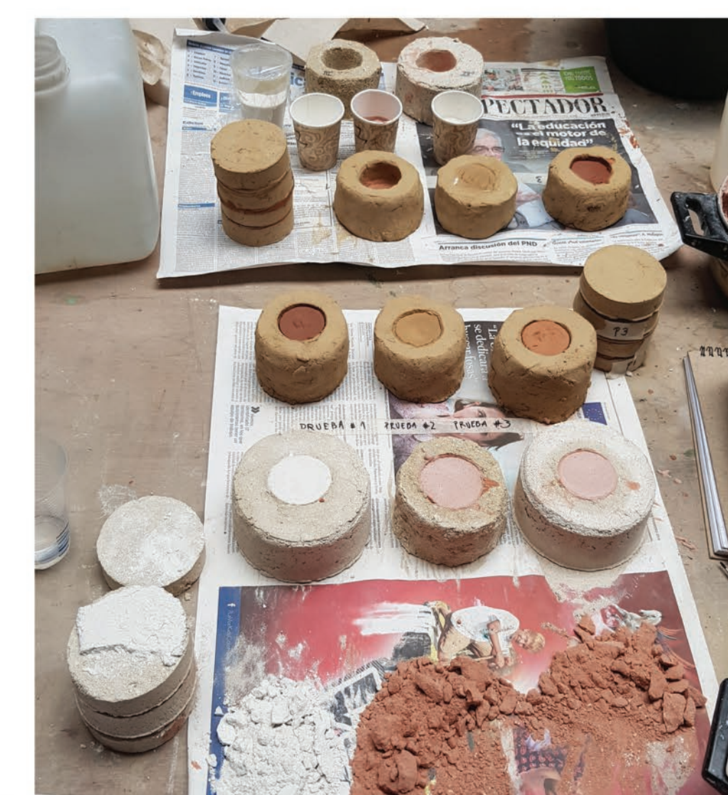
Materiales y pruebas realizadas para formular el mortero de inyección del hipogeo S12.
