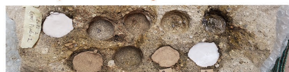
Pruebas de diferentes mezclas de morteros de inyección.
