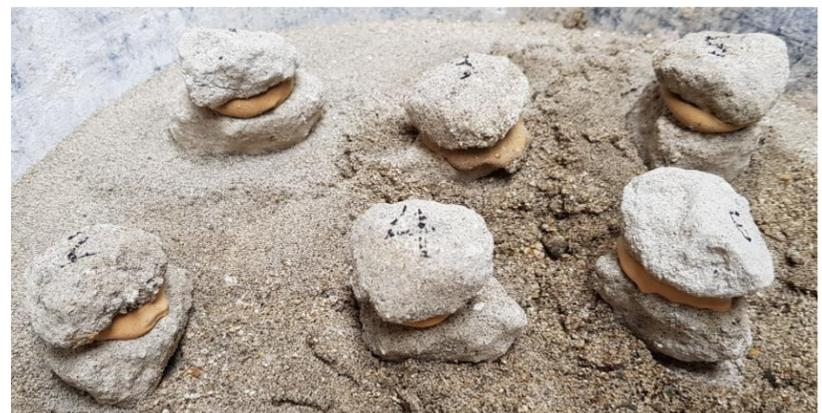
Sándwiches de toba empleados para pruebas de adhesión preliminar y adherencia final.
