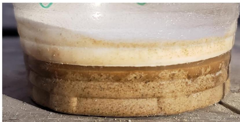
*Separación de estratos en una de las pruebas con silicato de etilo.*
