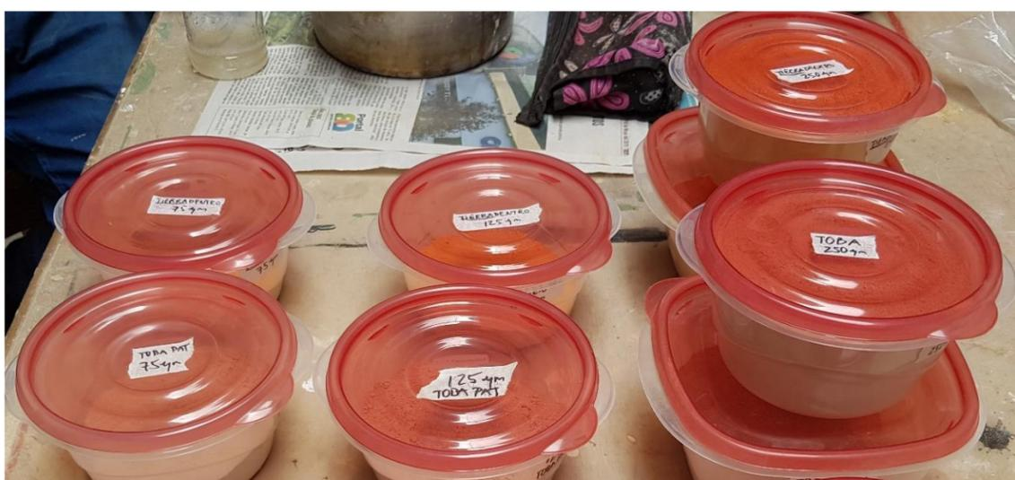
*Tierra arcillosa y toba proveniente cerca del Parque Arqueológico de Tierradentro tamizada en diferente granulometría para las pruebas del mortero de inyección.*
