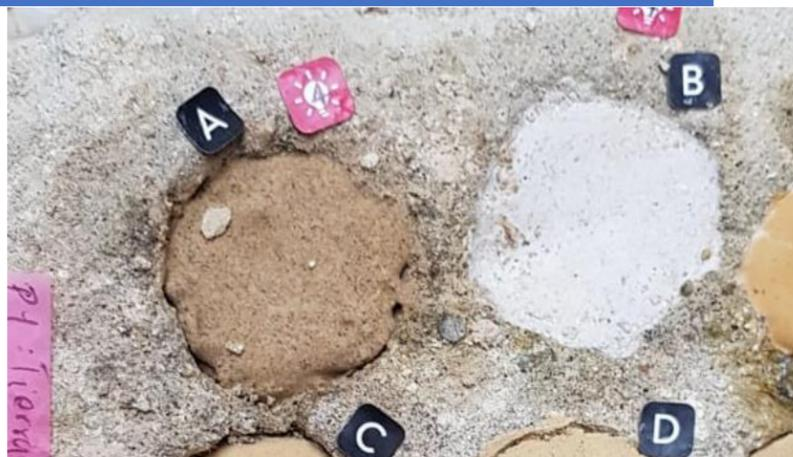
*Halo visible alrededor de las pruebas realizadas con silicato de etilo.*
