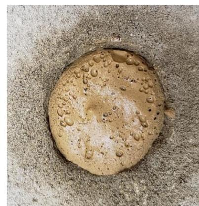
*Maqueta hecha en toba para medir la contracción del mortero durante el secado.*
