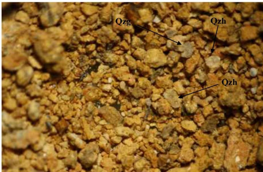
**Fotografía 1.** Aumento: 2.0. Fragmentos de cuarzo hialino (Qzh) y cuarzo gris (Qzg) visibles en una porción de muestra desintegrada.
