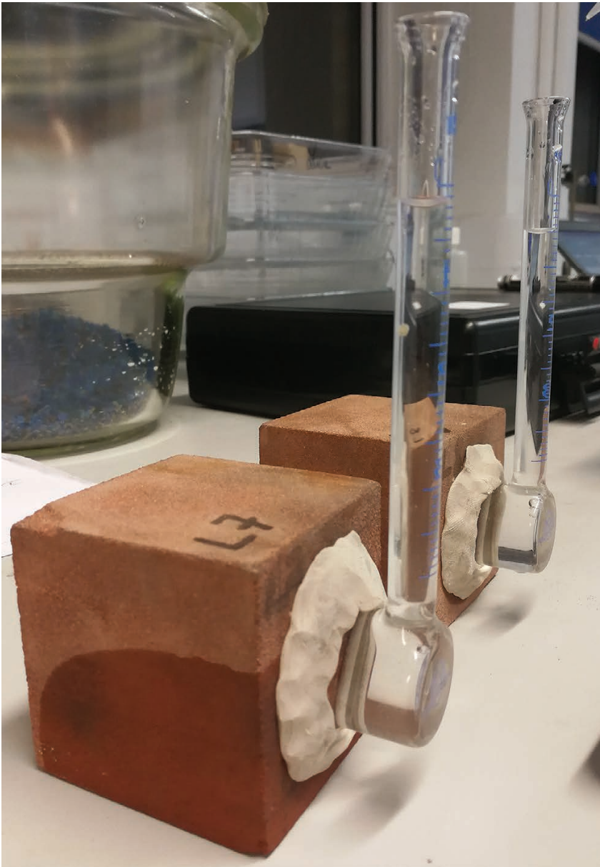
FIGURA 4.1. Tubos RILEM instalados sobre dos cubos de muestra a efectos de compararlos. La aplicación es similar cuando se aplica directamente a un edificio.
