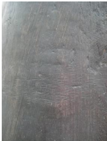
Fotografía 34 y detalle. Acercamiento a simple vista y con lupa de aumento 10x de una zona de soldadura donde se ve pueden ver las huellas de la herramienta para lograr el acabado final
