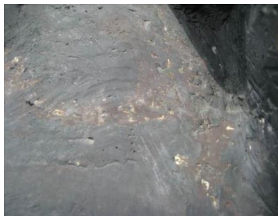
Fotografía 16. Zona de soldadura en el torso. En la imagen de la izquierda se puede ver la textura rugosa diferente a la del resto de la escultura
