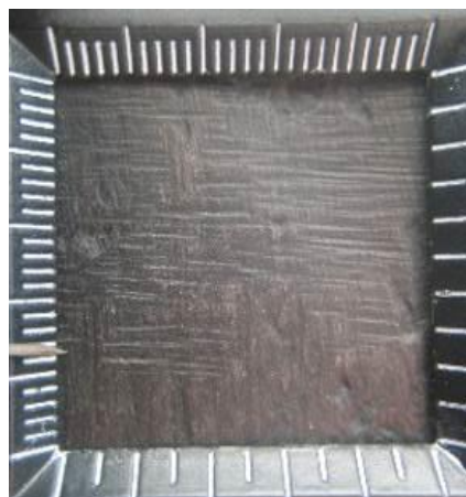
Fotografía 34 y detalle. Acercamiento a simple vista y con lupa de aumento 10x de una zona de soldadura donde se ve pueden ver las huellas de la herramienta para lograr el acabado final
