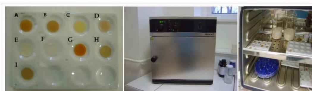
*Figura 3.9. Proceso de secado de las pastillas para su posterior análisis en el espectrómetro IR a una temperatura de 110°C.*
