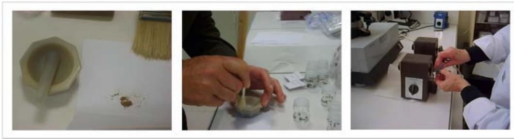
**Figura 3.4.** a) Triturado manual de la muestra. b) Proceso para homogenizar y disminuir el tamaño de los granos de la muestra. c) Cilindro y vibrador de imán.
