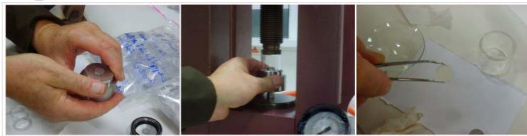
*Figura 3.8. Proceso de desmonte de la pastilla.*
