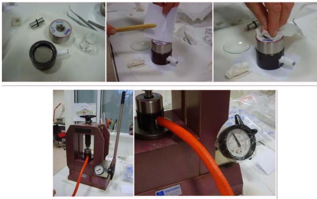
**Figura 3.7.** Prensado de la Pastilla. a) Elementos que componen el molde para pastillas. b) Introducción de la mezcla en el molde. c) Ajuste y sellado de la mezcla dentro del molde d) Prensa mecánica con el molde conectado al compresor. e) Manómetro que muestra la presión de 11 ton/cm<sup>2</sup>.
