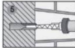
inyectar el adhesivo en el orificio, empezando desde el fondo, llevando la boquilla hacia atrás progresivamente. Evitar la entrada de aire. Para anclajes de cierta profundidad se puede utilizar un tubo alargador.
