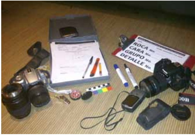
Equipo básico de documentación en campo: Cámaras, GPS, Escala IFRAO, Tabla de soporte, fichas, brújula, lápices, marcadores y pitos. Foto: Diego Martínez Celis, 2014
