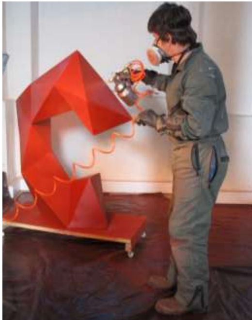
Foto 12: Aplicación pintura anticorrosiva roja.
