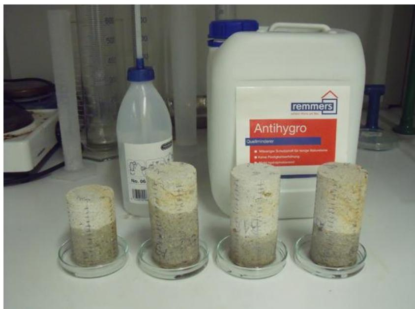
Figura 17: Para asegurar la impregnación homogénea de los núcleos, estos se separaron del porta objetos a una distancia de 0,5 cm. En esta foto se observa la impregnación que se hizo con el producto que disminuye la expansión hídrica.
