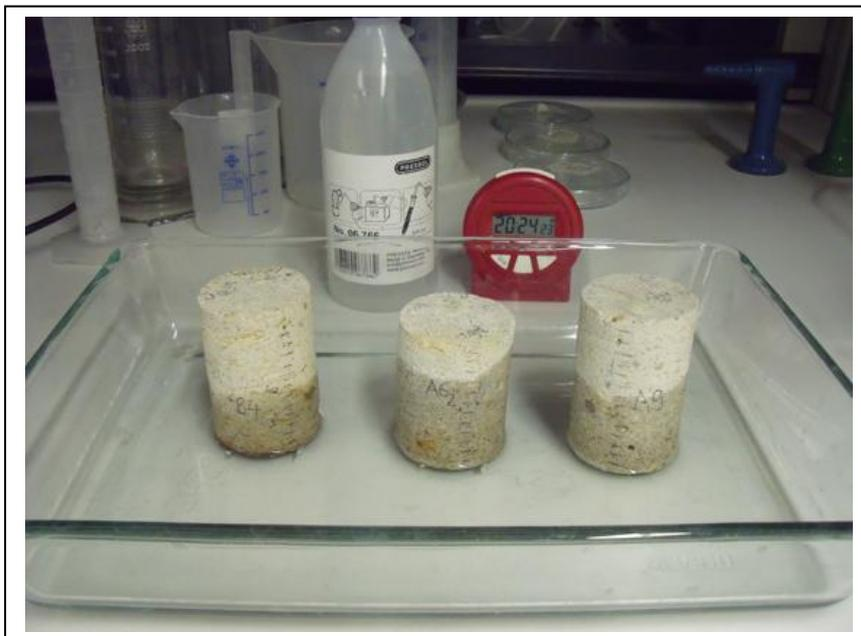
Figura 18: Núcleos durante la consolidación con silicato de etilo. Las marcas cada 5 mm facilitan estudiar la velocidad de la penetración.
