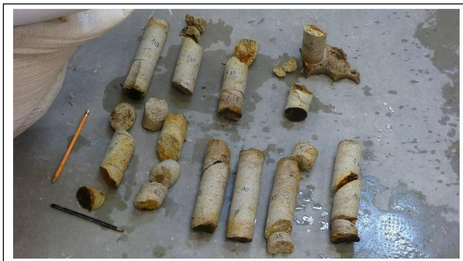
Figura 9: Núcleos que se extrajeron de la muestra A. La mayoría de estos núcleos se seccionaron debido a las discontinuidades características de la roca.
