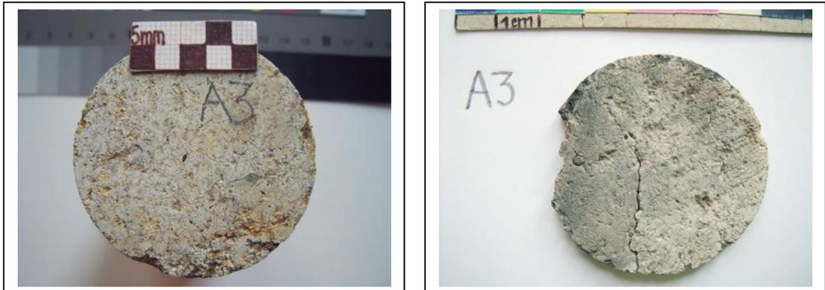
Figura 15: la muestra A3 antes y después de deterioro. Ya macroscópicamente se observa el deterioro de la muestra en donde además de partículas pequeñas disgregadas también se obtuvo una fisura más grande.
