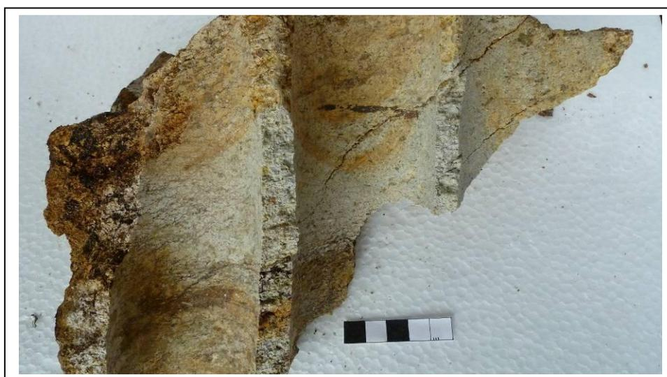
Figura 10. Detalle de la muestra A donde se observan discontinuidades dentro de la roca.
