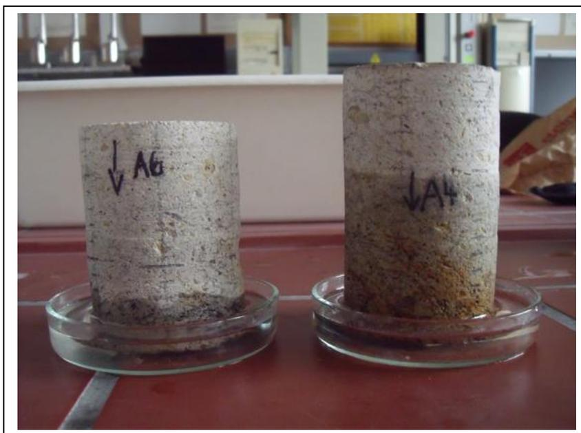
Figura 25: El estudio del coeficiente de absorción de agua en dos núcleos de la serie C. Aquí también se observa que mientras que en el núcleo A4 el horizonte de humedad es elevado, en el núcleo A6 el agua casi no ha ascendido.
