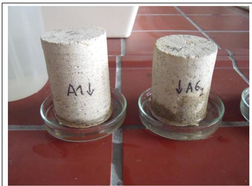
Figura 24: Dos núcleos de la serie A durante el estudio del coeficiente de absorción de agua. Se observa que si bien los dos núcleos pertenecen a la misma serie y deberían mostrar un comportamiento similar, un núcleo casi no absorbe agua mientras que el otro (A6-2) presenta un horizonte de humedad más elevado.
