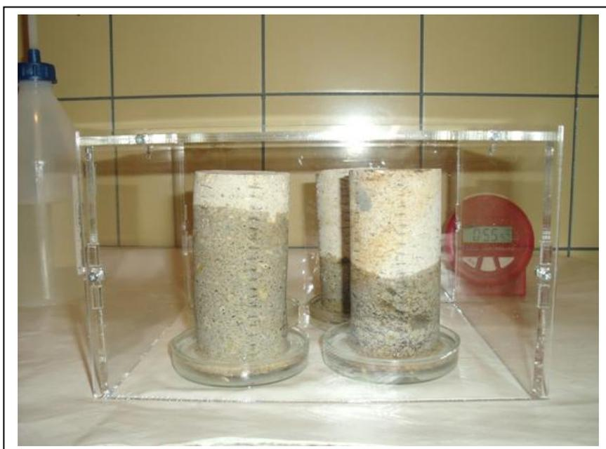
Figura 19: Núcleos de la serie B, los dos del frente son el A3 y A7. En ambos se empezó la impregnación con el ácido tártrico al mismo tiempo, pero después de varias horas se observaba que los horizontes de humedad habían llegado a niveles muy diferentes.
