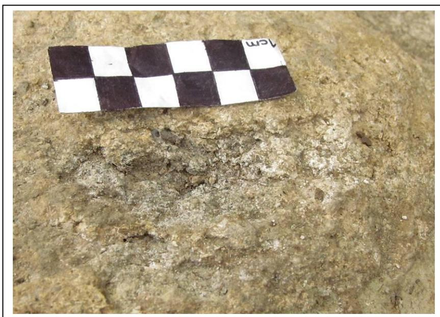
Figura 5: Zona con decohesión dónde se observan fisuras con dimensiones entre 200  $\mu\text{m}$  y hasta más de 1 mm y partículas más grandes disgregadas.
