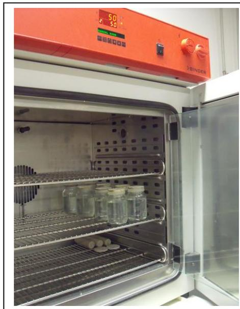
Figura 22: Las muestras para estudiar la permeabilidad al vapor de agua se guardan en una cámara climática.
