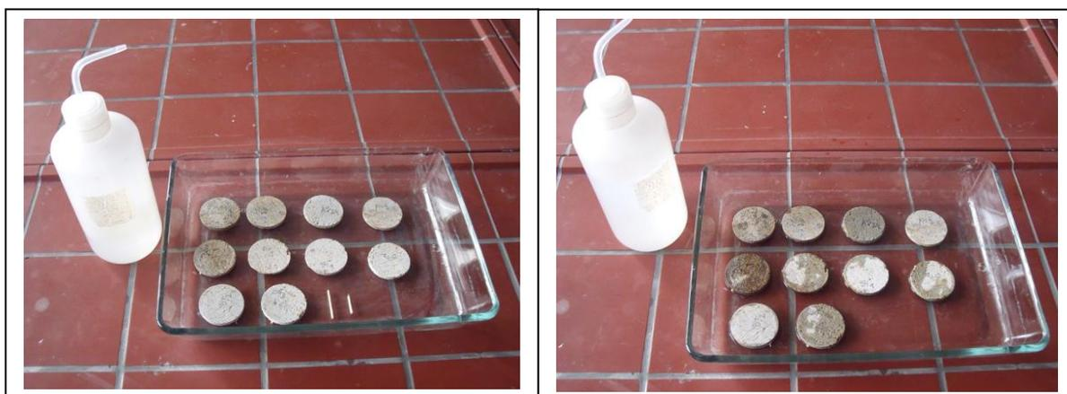
Figura 20: En el estudio de la porosidad accesible al agua las muestras deben absorber agua por capilaridad y después se sumergen 48 horas bajo una capa de 2cm de agua.
