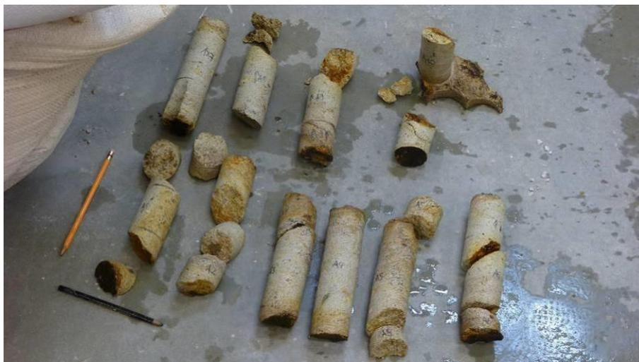
Figura 51: Núcleos que se extrajeron de la muestra Algunos de estos núcleos se seccionaron debido a las discontinuidades características de la roca.
