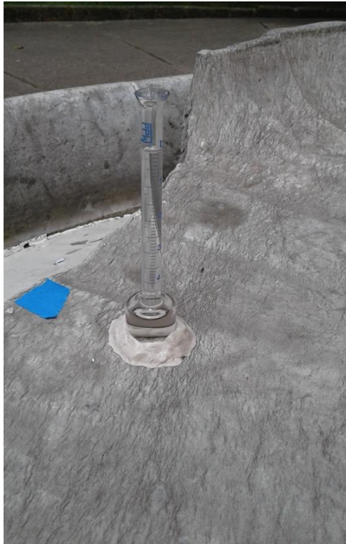
Foto 5: En la foto se observa la ejecución del estudio de la absorción de agua en el punto 1.
