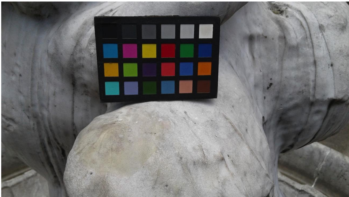
Foto 9: La foto presenta el punto de medición 2 después del estudio. Se observa el horizonte de humedad que se formó durante la medición.
