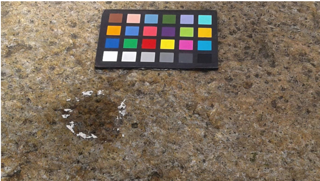
Foto 14: La foto muestra el horizonte de humedad que se formó durante el estudio de la absorción.
