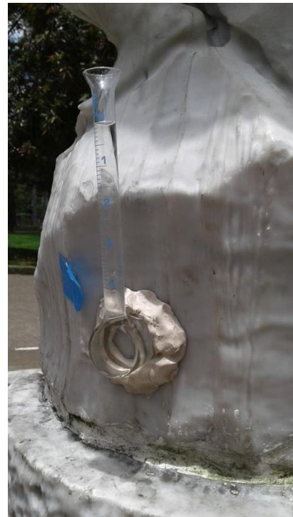
Foto 11: La foto presenta la ejecución del estudio de la absorción de agua en el punto 3.
