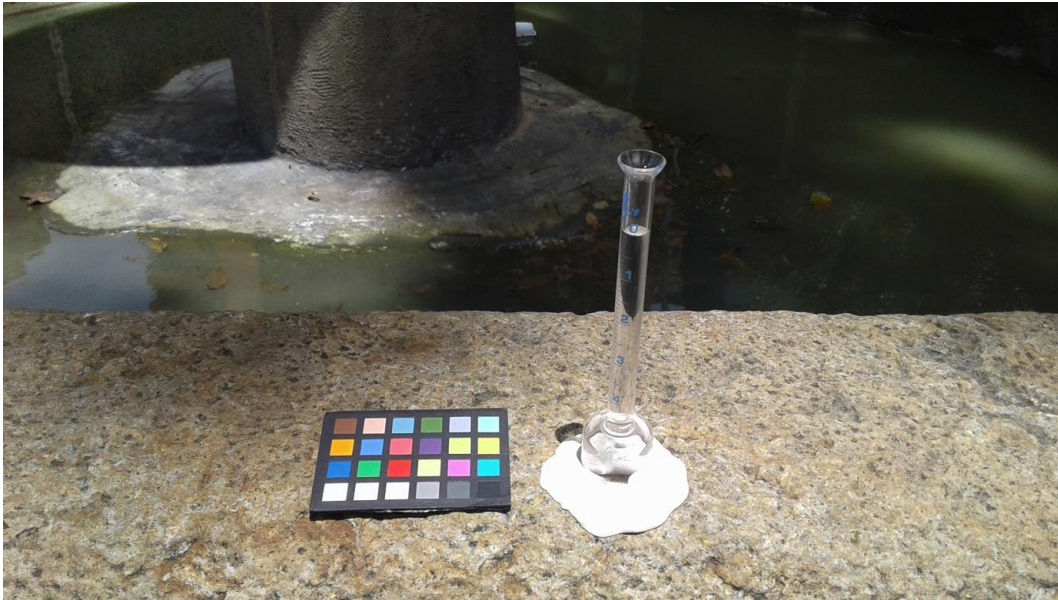
Foto 13: En la foto se observa el estudio de la absorción de agua en el punto 1.
