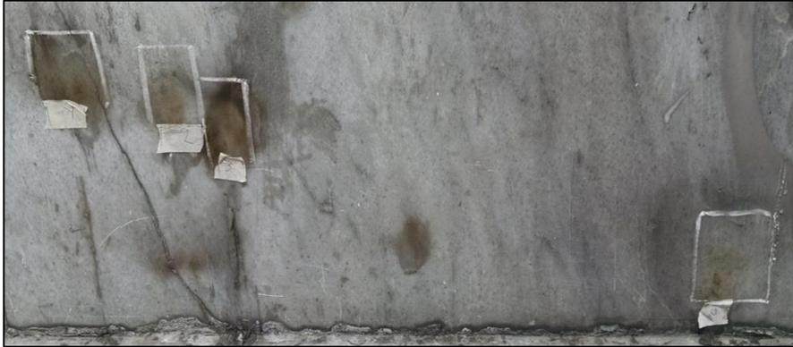
Fotografía 42: Prueba L11 que registra el resultado de la prueba de limpieza del grafiti de esta zona con los diferentes solventes, dando como resultado que el solvente con mejores
