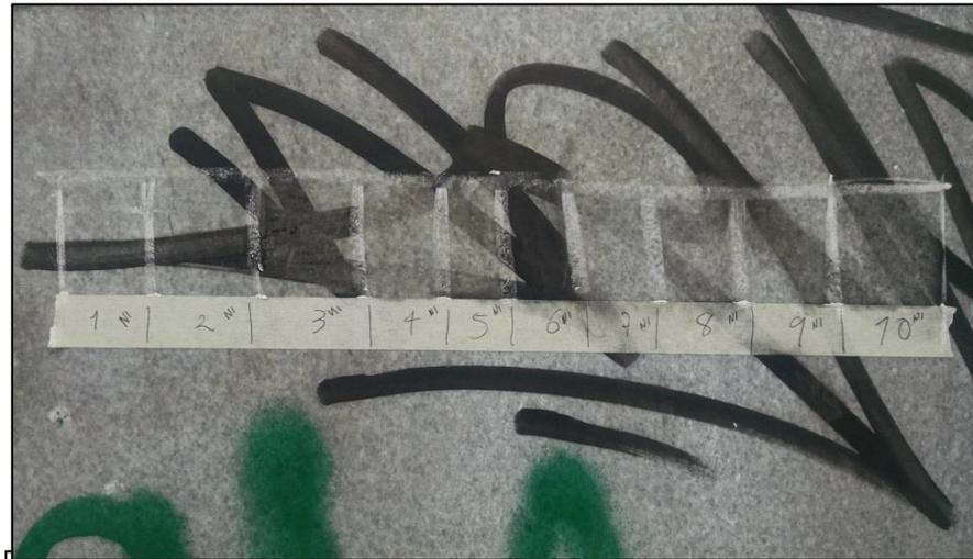
Fotografía 33; Prueba L4 que registra el resultado de la prueba de limpieza del grafiti de esta zona con los diferentes solventes, dando como resultado que el solvente con mejores resultados es **QUITA GRAFITI FORTE, Quita grafiti en gel,**
