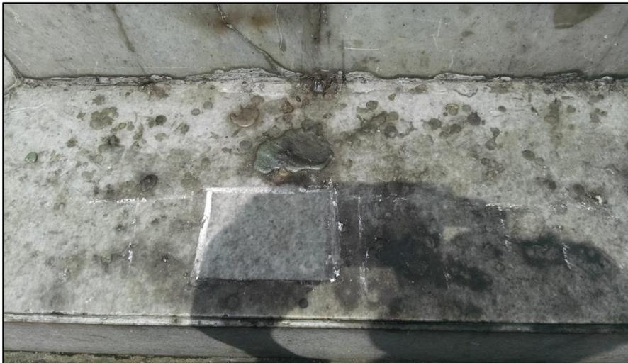
Fotografía 43: prueba L12, Fotografía que registra el resultado de la prueba de limpieza del grafiti de esta zona, por medios mecánicos con bisturí y posteriormente con **Varsol** para eliminar los residuos.
