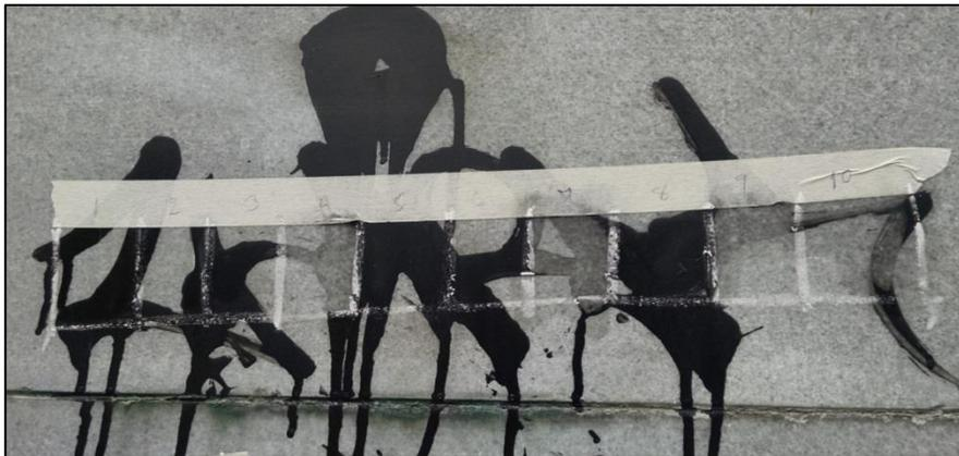
Fotografía 39: Prueba L8 que registra el resultado de la prueba de limpieza del grafiti de esta zona con los diferentes solventes, dando como resultado que el solvente con mejores resultados es **Acetona.**
