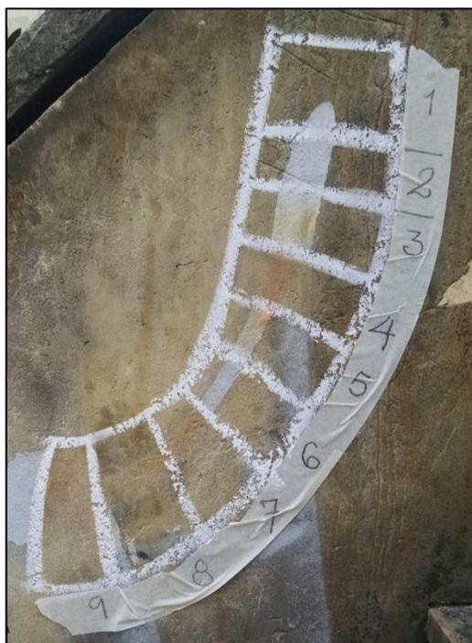
Fotografía 73. Prueba L19 que registra el resultado de la prueba de limpieza del grafiti de esta zona con los diferentes solventes, dando como resultado que el solvente con mejores resultados es **Acetona**
