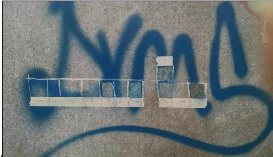
Fotografía 37: Prueba L7 que registra el resultado de la prueba de limpieza del grafiti de esta zona con los diferentes solventes, dando como resultado que el solvente con mejores resultados es **Thinner**.
