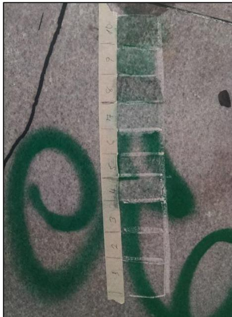
Fotografía 32: Prueba L3 que registra el resultado de la prueba de limpieza del grafiti de esta zona con los diferentes solventes, dando como resultado que el solvente con mejores resultados es el QUITA GRAFITI FORTE, Quita grafiti en gel,
