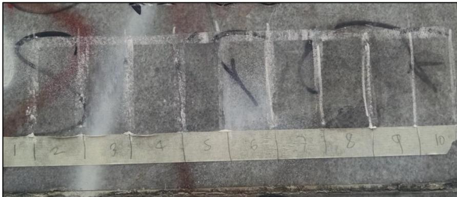
Fotografía 46: Prueba L14 que registra el resultado de la prueba de limpieza del grafiti de esta zona con los diferentes solventes, dando como resultado que el solvente con mejores resultados es **A2- D1** (Acetato de etilo y dimetil formamida 2:1).
