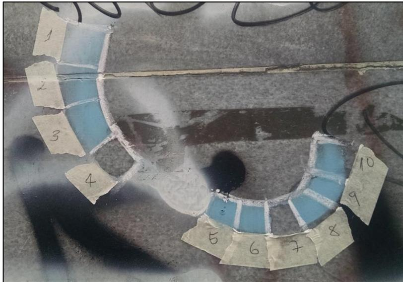
Fotografía 47: prueba L15 que registra el resultado de la prueba de limpieza del grafiti de esta zona con los diferentes solventes, dando como resultado que el solvente con mejores resultados es **A2- D1** (Acetato de etilo y dimetil formamida 2:1).
