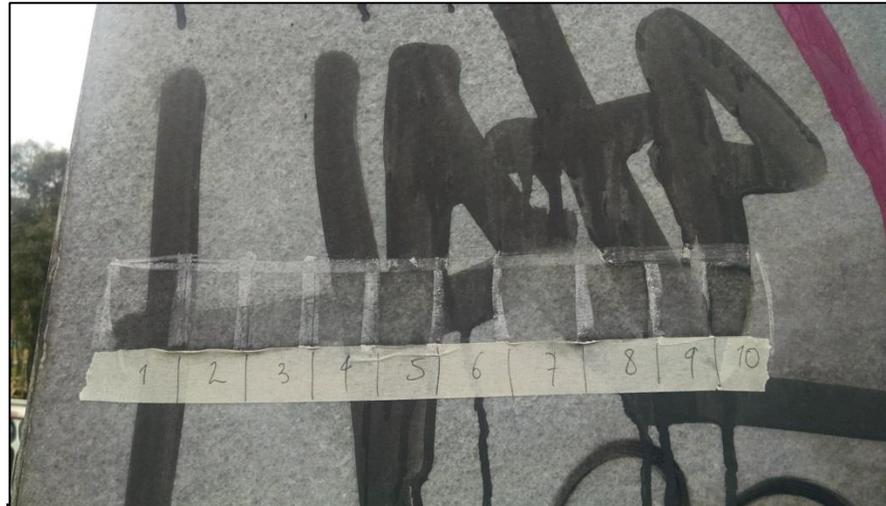
Fotografía 30: Prueba L1 que registra el resultado de la prueba de limpieza del grafiti de esta zona con los diferentes solventes, dando como resultado que el solvente con mejores resultados es **A2- D1** (Acetato de etilo y dimetil formamida 2:1),
