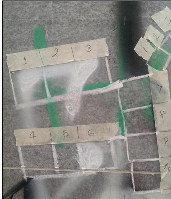
Fotografía 48: prueba L16 que registra el resultado de la prueba de limpieza del grafiti de esta zona con los diferentes solventes, dando como resultado que el solvente con mejores resultados es **A2- D1** (Acetato de etilo y dimetil formamida 2:1).
