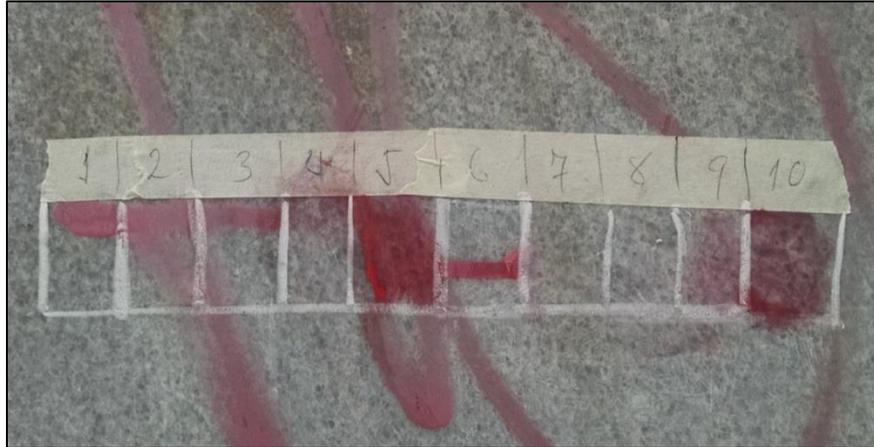
Fotografía 35: Prueba L5 que registra el resultado de la prueba de limpieza del grafiti de esta zona con los diferentes solventes, dando como resultado que el solvente con mejores resultados es **QUITA GRAFITI Taqaway**.
