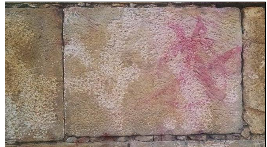
Figura 13: Área L3, Fotografía que registra el resultado de la limpieza de los grafitis de esta zona con el solvente seleccionado en las pruebas de limpieza (Quita grafiti en gel FORTE).
