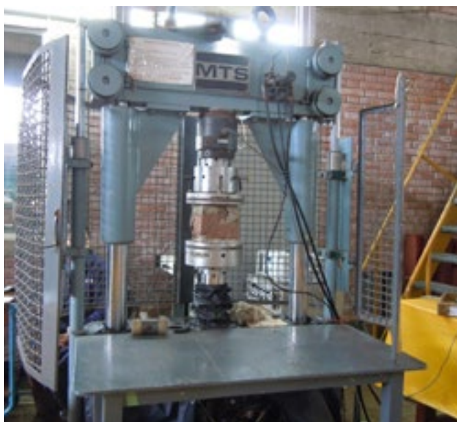
FIGURA 2.1 Prueba de resistencia a la compresión de los adobes del Templo Santiago Apóstol de Kuñotambo. Foto: PUCP
